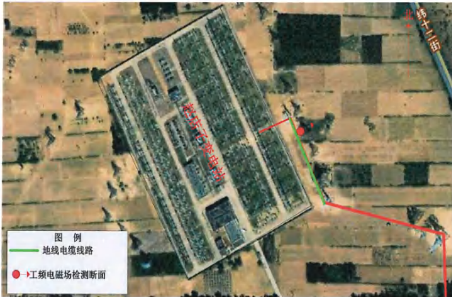
图 7-2 地下输电电缆电磁环境检测布点图
