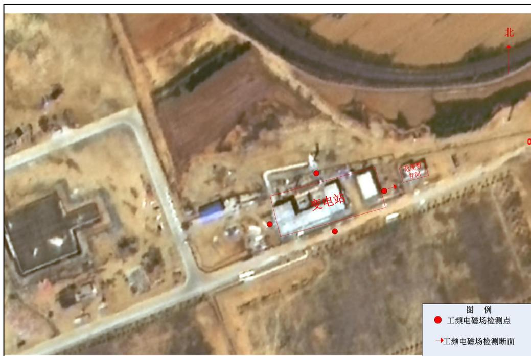
图 7-1 变电站电磁环境检测布点图
