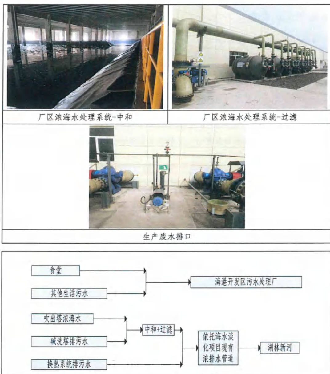
图 4.1-1 废水治理流程示意图
