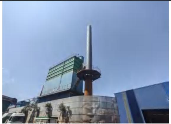
卸料工序脉冲布袋除尘器
