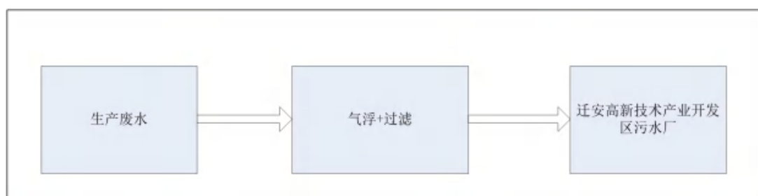
图 4.1-2 污水处理工艺流程示意图
