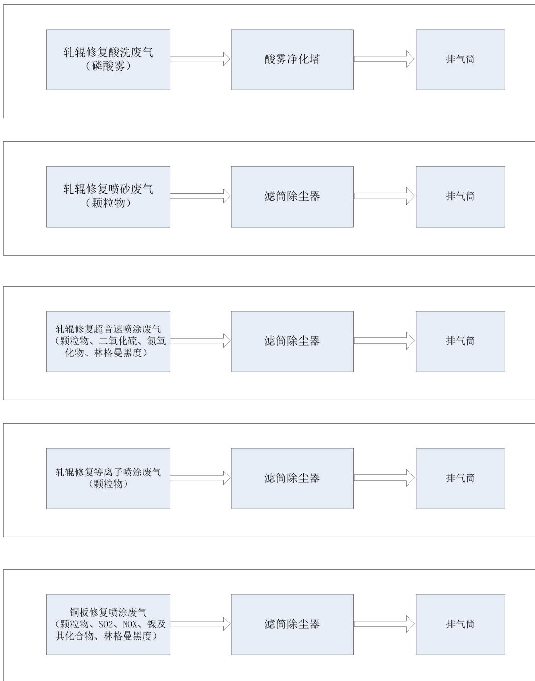
图 4.1-1 废气治理工艺流程示意图
