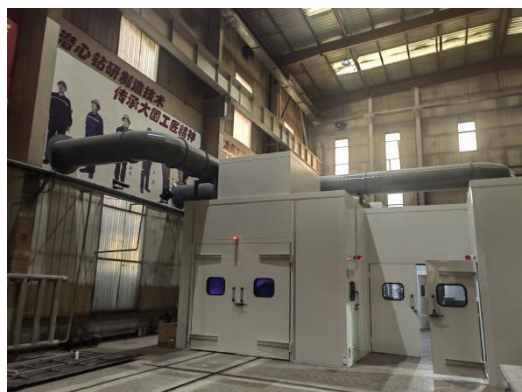
封闭式等离子喷涂房
