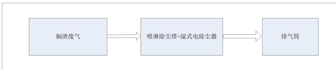
图 4.1-1 废气治理工艺流程示意图
