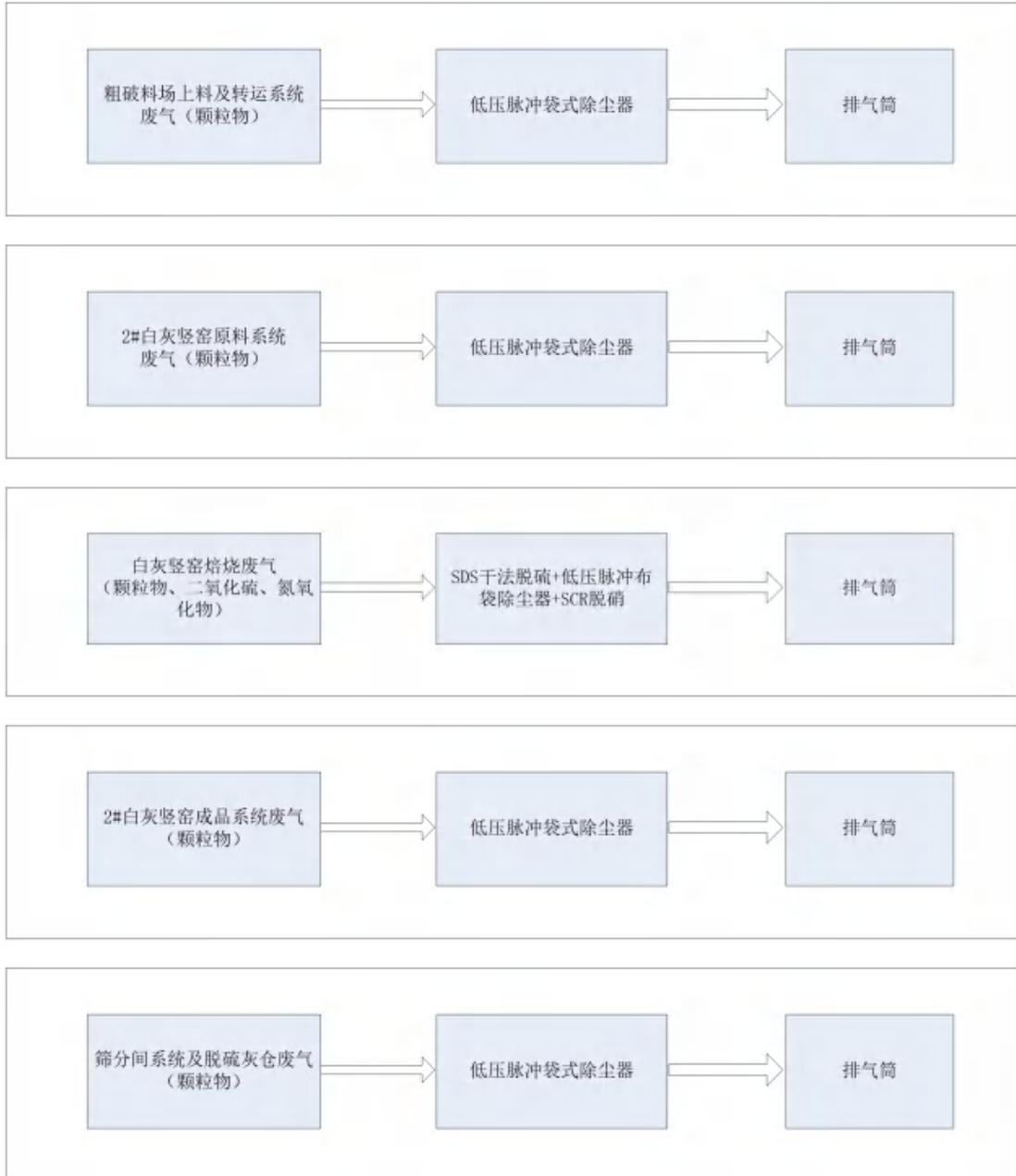
图 4.1-1 废气治理工艺流程示意图
