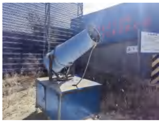
原料堆场雾炮
