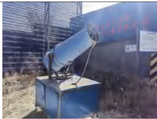
原料堆场雾炮
