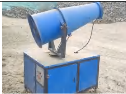
原料堆场雾炮
