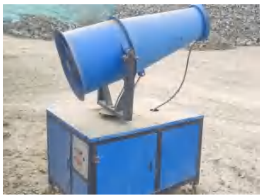
原料堆场雾炮
