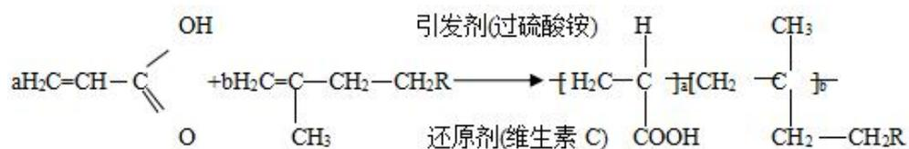
R为： $-\left[ \text{CH}_2-\text{CH}_2-\text{O} \right]_n-\text{H}$
