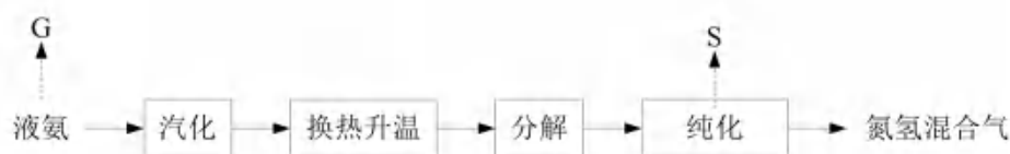
图 3.9-2 氨分解工序工艺流程及产排污节点
