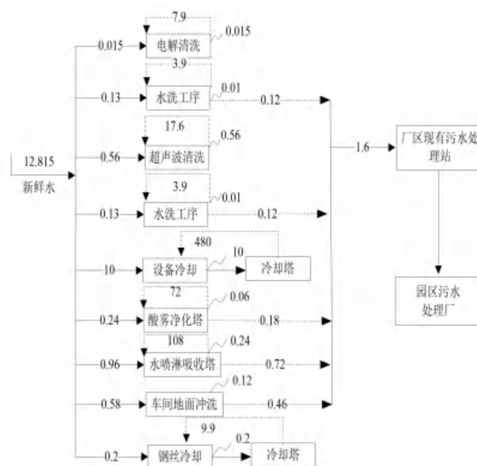
图 3.8-1 项目改建后给排水平衡图 单位：m³/d
