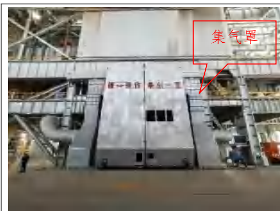
转炉设置挡火炉门+两侧收集
